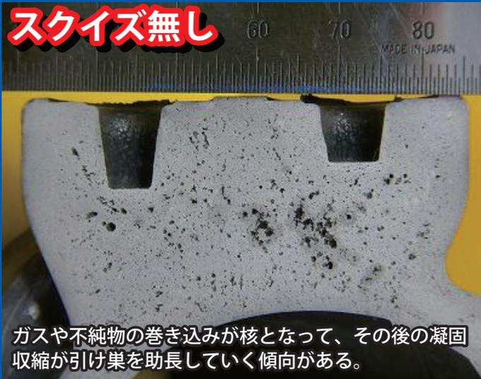
ガスや不純物の巻き込みが核となって、その後の凝固収縮が引け巣を助長していく傾向がある。
