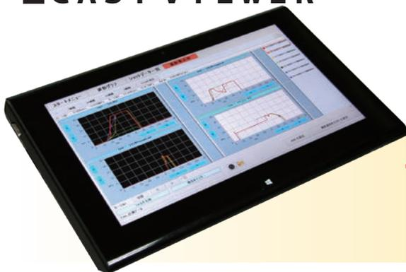
CAST VIEWER とはセンサから出力される電圧を波形として表示する事が出来るデバイスです。CAST VIEWER をご使用いただく事で鑄造条件の「見える化⇒分析」が出来る為、スクイズ管理や生産性向上を図る事が出来ます。
